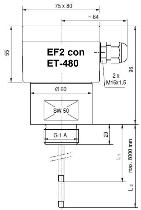
**1.4.1.2 Disegni quotati per rilevatori standard di tipo EE-**
