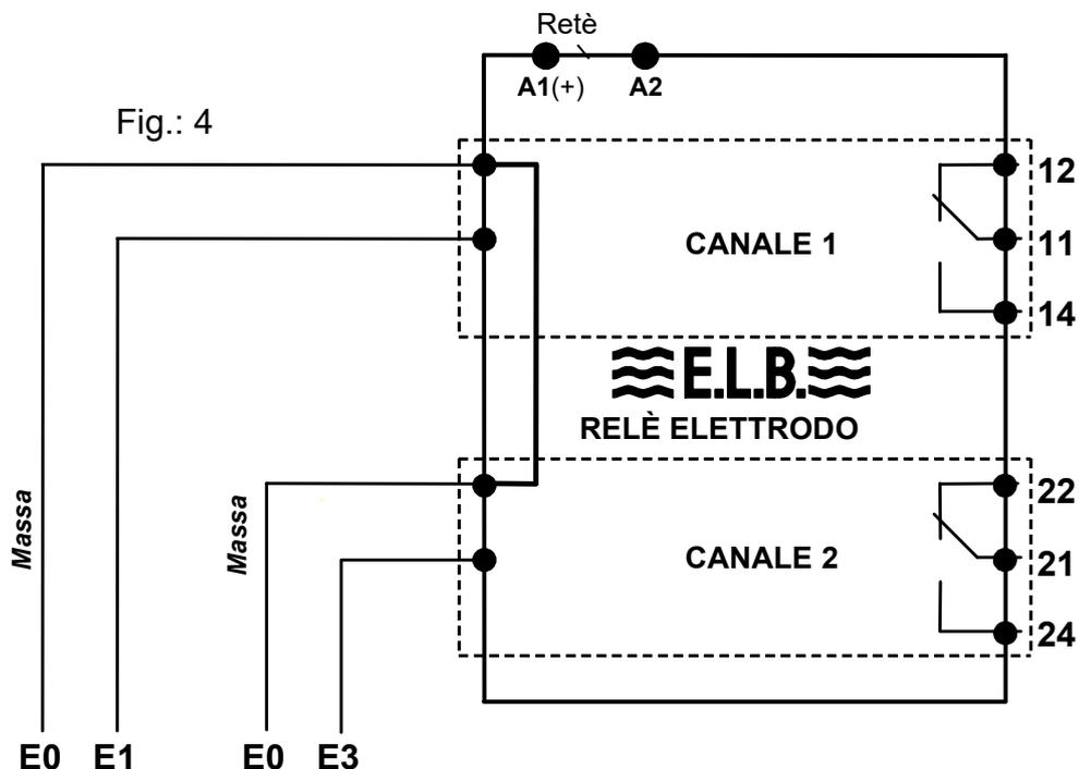
Il collegamento del rilevatore di contatori (1) al convertitore di misura (2) deve avere luogo sui morsetti contrassegnati con "E0", "E1" o "E3". Il collegamento alla rete del convertitore di misura ER-117.. o ER-217.. va istituito sui morsetti contraddistinti con "A1" e "A2".
