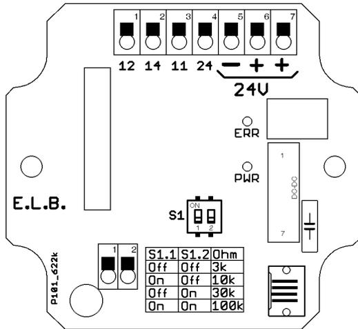
Il collegamento alla rete del convertitore di misura ET-470.. va istituito sui morsetti contraddistinti con “+24V” e “-24V” (20 ... 35VDC).
