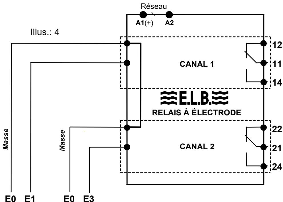
Le raccordement du détecteur de niveau (1) au transducteur de mesure (2) doit se faire au niveau des bornes **E0**, **E1** et **E3**. Le raccordement au réseau du transducteur ER-117.. ou ER-217.. se fait au niveau des bornes **A1** et **A2**.
