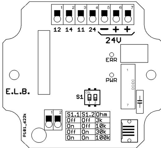
Le raccordement au réseau du transducteur ET-470.. se fait au niveau des bornes **+24V** et **-24V** (20 ... 35 VDC). Le relais de sortie fonctionne en mode veille, bornes **11**, **12** et **14**.
