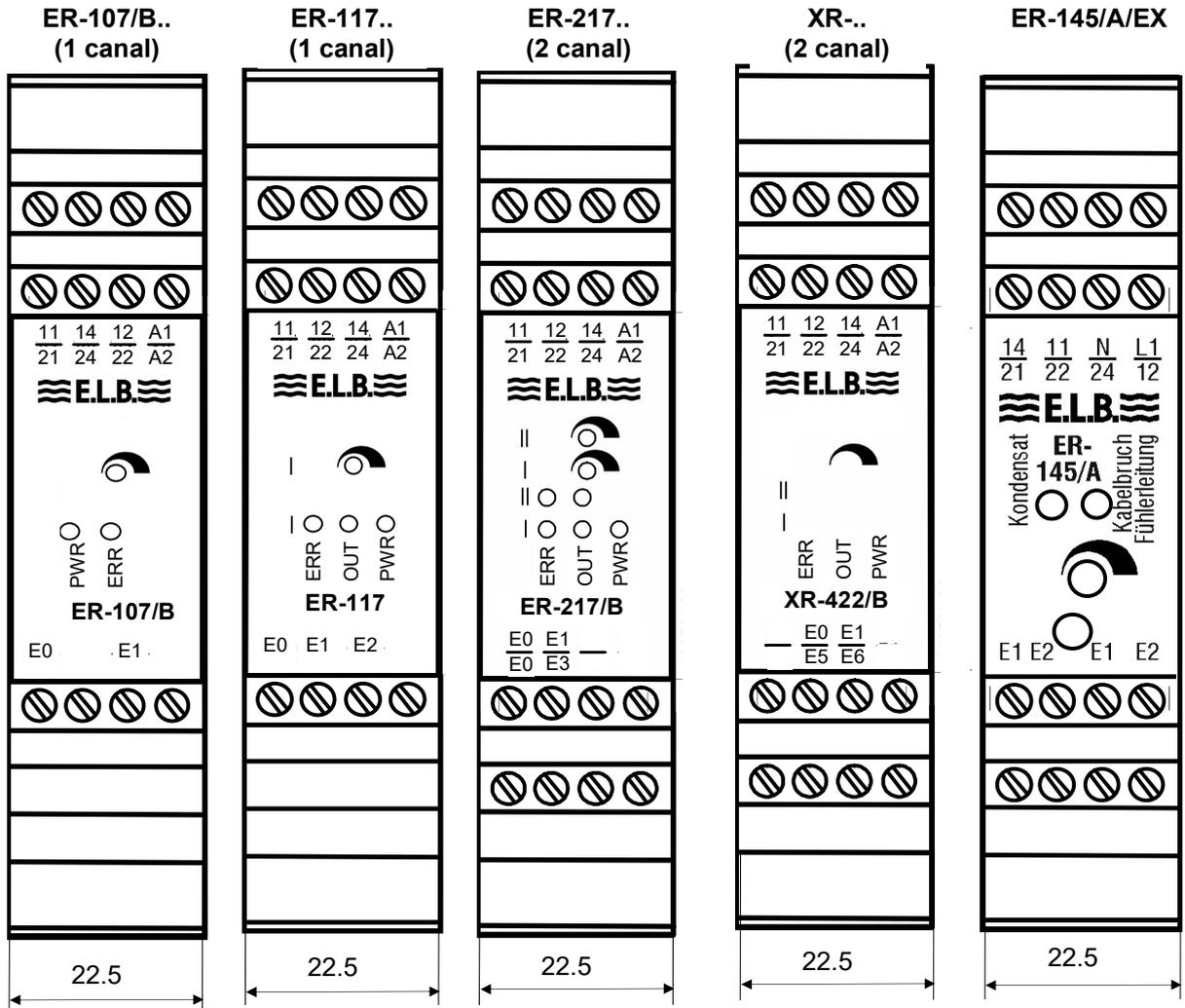
\* ERR = rupture de conduite, OUT = électrode mouillée, PWR = réseau
