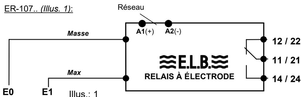
Le fil de signal doit être raccordé aux deux connexions du détecteur de niveau (en cas de prise, aux connexions 1 et 2).
